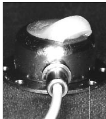
Membranet hade lossnat i ena kanten, vilket orsakade ett läckage.
