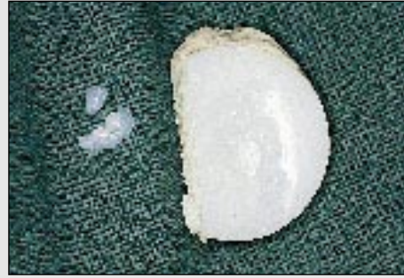
Figur 2. Polyetylenledytan på denna enkammartibiakomponent har delaminerats.
