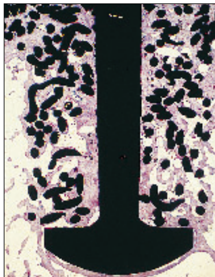
Figur 4. Pegg från knäprotes med porös yta av titanfibertrådar som visar god inväxt av ben.
