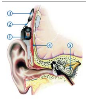
Figur 1. Typmodell av funktionen hos ett kokleaimplantat: 1. Ljud tas emot av mikrofonen och omvandlas till elektriska signaler. 2. Förbindelse mellan utanpåliggande mikrofonenhet och talprocessor. 3. Signalen når talprocessorn där den kodas om. 4. Den kodade signalen skickas trådlöst till den implanterade enheten och dess elektrod. 5. Signalerna når koklean och går vidare i hörselnerven till nucleus cochlearis och hörselkortex. (Publiceras med tillstånd från MED-EL Cochlear Implants.)
