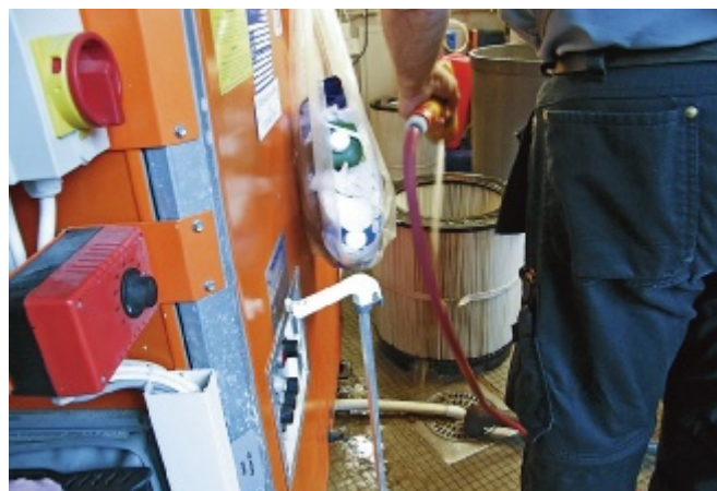
Figur 2. Rengöring av filter med vattenslang.
