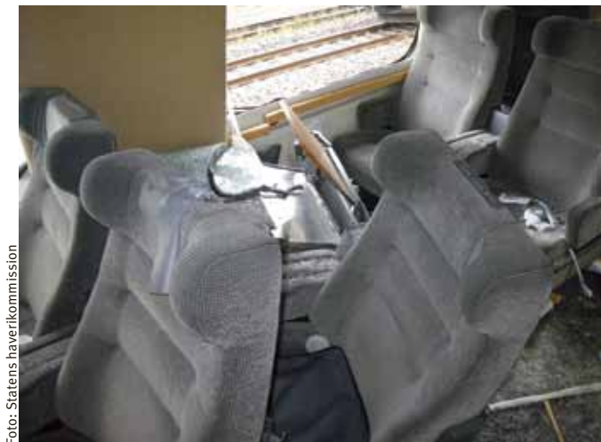
Figur 2. I vagn 2 slogs fönster in, och ett stolspar lossnade. Här satt passageraren som avled, fastklämd under framförvarande stolspar.
