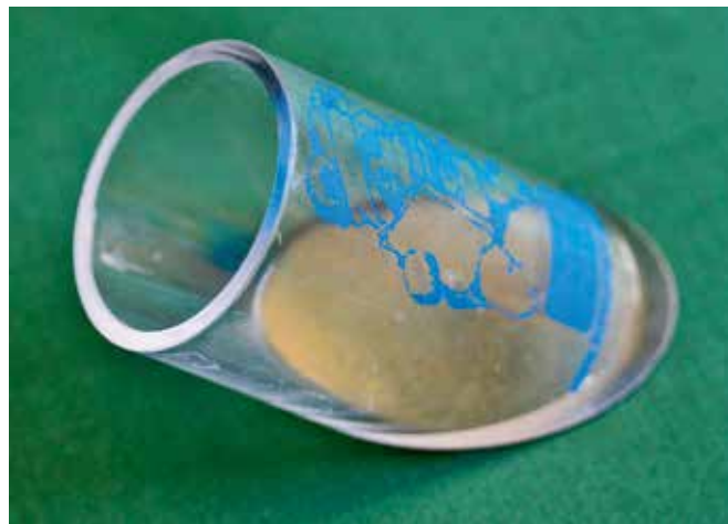
Testcylinder för leksaker. Om föremålet ryms i sin helhet i cylindern – diameter 31,75 mm – anses det inte säkert för barn under 3 år.
