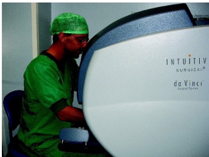
Vid robotkirurgi krävs två kirurger; en huvudoperatör som styr robotinstrumenten vid robotkonsolen och har en 3D-bild av operationsfältet, samt en assisterande kirurg som arbetar vid patienten med konventionell laparoskopisk teknik och ser operationsfältet i 2D-bild.
