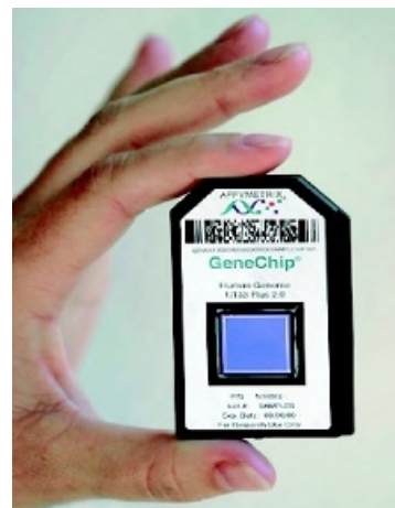
Figur 2. Ett DNA-mikromatrischip. DNA-sekvenser motsvarande 40 000 gener och genvarianter är fästa på glasplattan mitt i chippet och används för att mäta motsvarande mRNA-uttryck i det prov som ska analyseras.
